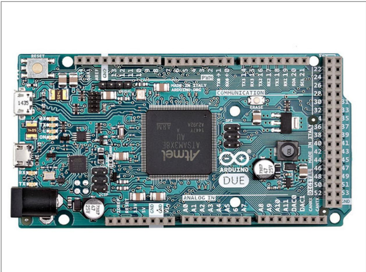
Arduino Due è la più recente scheda a microcontrollore nella famiglia Arduino. E' la prima scheda basata su un processore a 32 bit (Atmel SAM3X8E ARM Cortex-M3 MCU), che migliora tutte le funzionalità standard di Arduino ed introduce molte nuove prestazioni.
